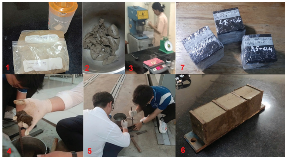
Hình 2.5. Một số bước trong quá trình đúc mẫu polymer đất sét: định lượng đất sét, tro bay và geopolymer theo tỷ lệ, lần lượt là quy trình đúc khuôn nén mẫu bằng tay, mẫu thử có độ dẻo đặc cao, dễ nén, Mẫu thử sau khi đúc khuôn và bảo quản sản phẩm
