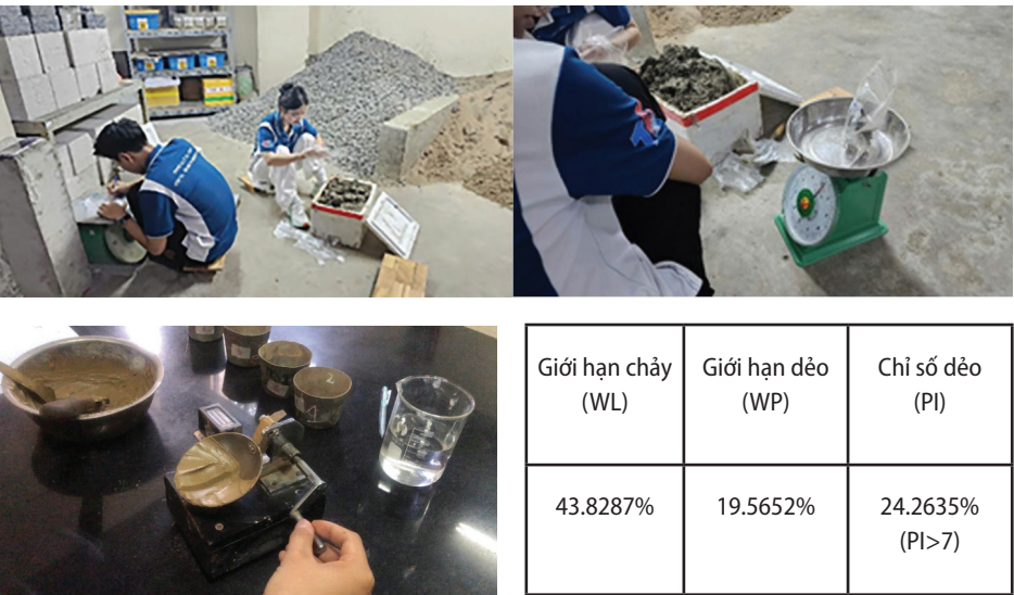
Hình 2.2. Xác định giới hạn chảy bằng phương pháp Casagrande
