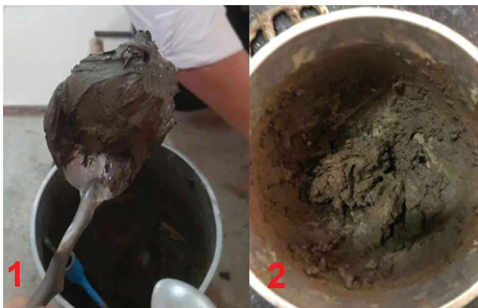
Hình 3.5. Hai mẫu ví dụ cho việc tỷ lệ mẫu chưa tối ưu dẫn đến hiện tượng “quá nhão”, không đạt độ dẻo nhất định để đúc khuôn
