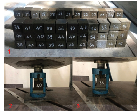
Hình 2.6 Mẫu chọn lọc để nén và đo cường độ
