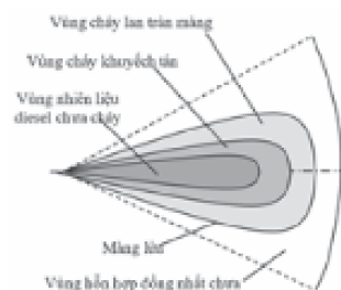
Hình 2. Sơ đồ phân vùng xilanh ứng với 1 tia phun trong quá trình cháy.
