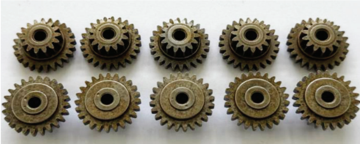
Sản phẩm bánh răng thẳng hai tầng do nhóm nghiên cứu chế tạo. Ảnh: Nhóm nghiên cứu.
