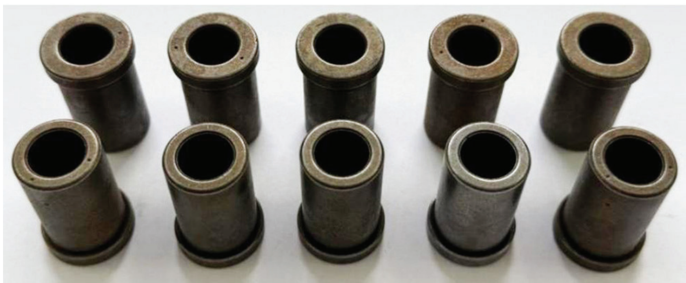
Sản phẩm bạc xốp tự bôi trơn được nhóm thiết kế, chế tạo. Ảnh: Nhóm nghiên cứu.
