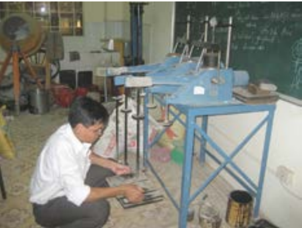
Hình 4. Gia tải nén tĩnh xác định mô đun đàn hồi của bê tông nhựa
