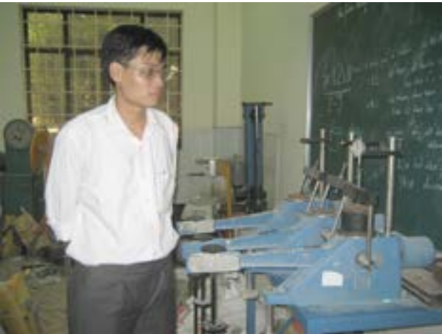
Hình 5. Theo dõi chuyển vị kế - thí nghiệm nén tĩnh xác định mô đun đàn hồi của bê tông nhựa
