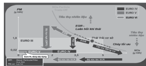
Hình 1. Các giải pháp giảm phát thải PM và NO x nhằm hướng tới các tiêu chuẩn Châu Âu [4]
