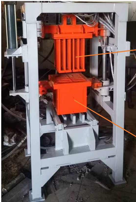
Hình 29: Lắp đặt khuôn đực và cái lên máy ép gạch block 4 lỗ
