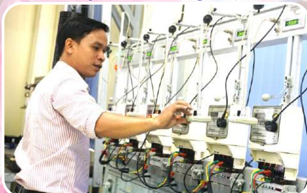
Kiểm định công tơ điện.
