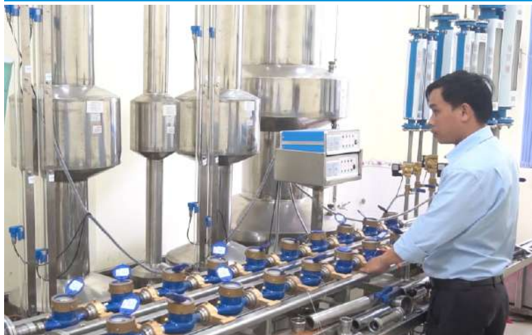
Nhân viên Trung tâm Ứng dụng và Dịch vụ khoa học công nghệ tỉnh Quảng Ngãi đang kiểm định, đo lường, hiệu chuẩn đồng hồ nước.
