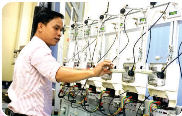
Kiểm định công tơ điện.
