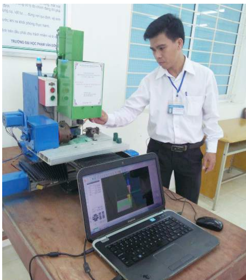
Giải pháp Thiết kế và chế tạo máy phay CNC mini 4 trục của thầy giáo Nguyễn Hoàng Linh.
