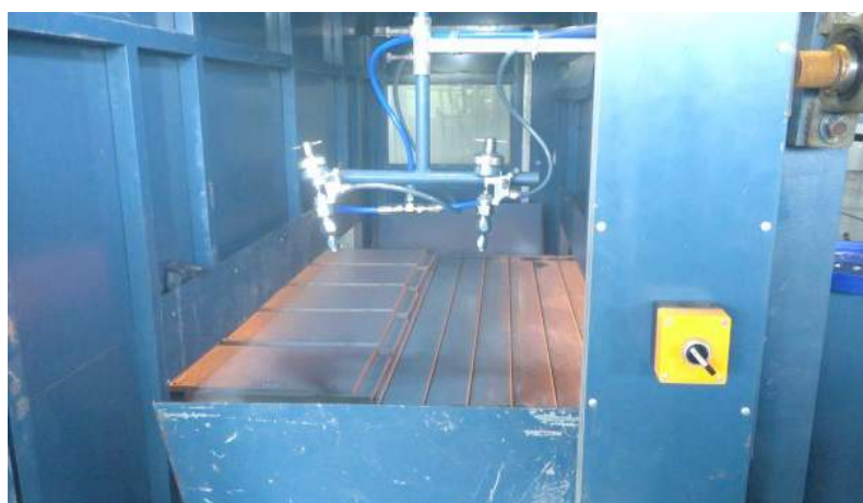
Dây chuyền công nghệ sơn ngói trong nhà máy gạch ngói không nung của Công ty TNHH xây lắp và thương mại AMC đã được đầu tư đổi mới.
