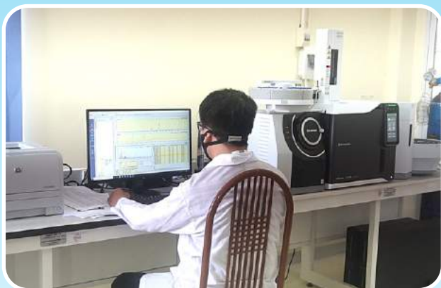
Hệ thống máy sắc ký khí (dùng để phân tích dư lượng thuốc BVTV trong nông sản, hợp chất hữu cơ trong nước).
