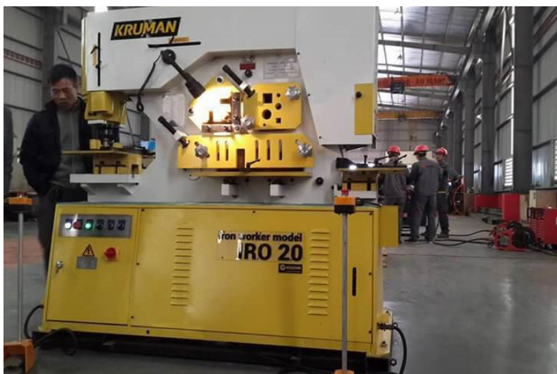
Máy đột dập liên hợp model IRO 20 của Công ty Cổ phần Cơ khí và Xây lắp An Ngãi tham gia Chương trình đổi mới thiết bị, công nghệ trong lĩnh vực sản xuất kết cấu thép.
