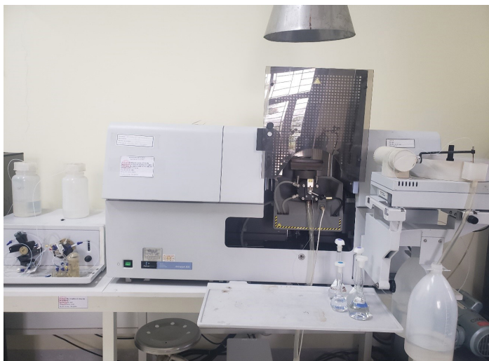
Thiết bị AAS dùng phân tích kim loại nặng trong nước sạch được trang bị tại Trung tâm Ứng dụng và Dịch vụ KHCN tỉnh Quảng Ngãi.
