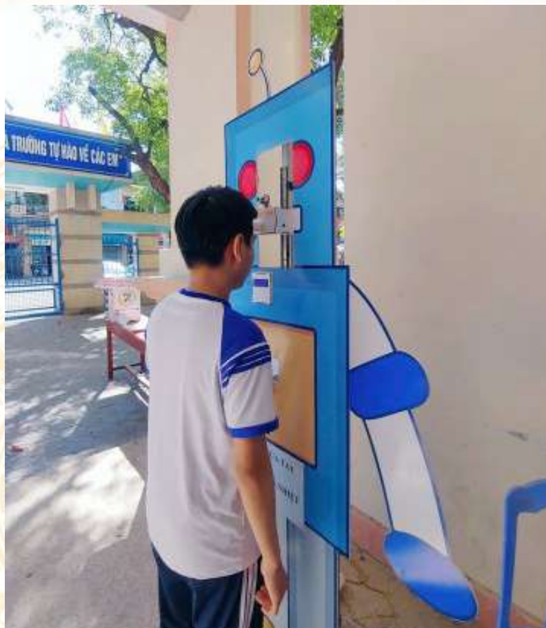
Thiết bị đo thân nhiệt không tiếp xúc và rửa tay sát khuẩn tự động.
