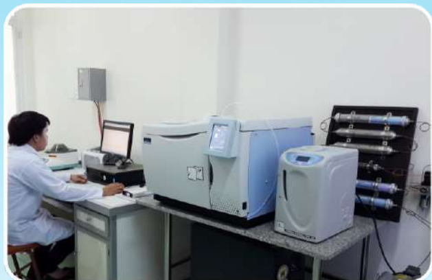
Hệ thống máy sắc ký khí (dùng để phân tích dư lượng thuốc BHTV trong nông sản, hợp chất hữu cơ trong nước).
