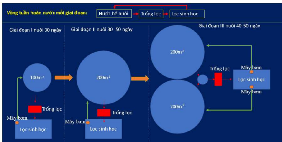
Hình 1. Sơ đồ mô hình nuôi tôm thẻ chân trắng và tôm sú tuần hoàn nước (RAS)
