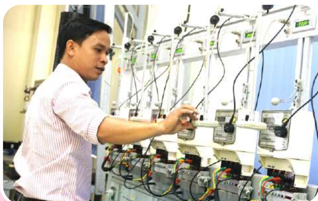
Kiểm định công tơ điện.
