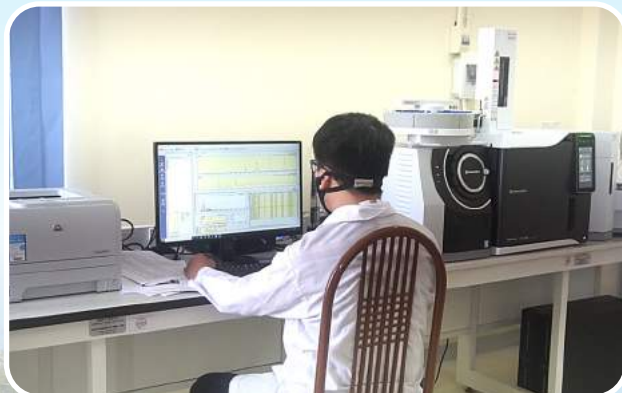
Hệ thống máy sắc ký khí (dùng để phân tích dư lượng thuốc BVTV trong nông sản, hợp chất hữu cơ trong nước).
