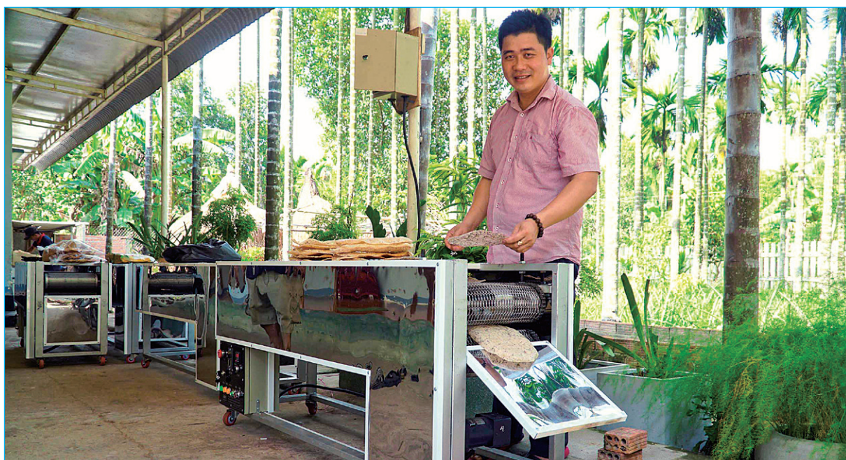
Máy nướng bánh tráng bằng tia hồng ngoại của kỹ sư Nguyễn Nở - đạt giải Nhất Cuộc thi Khởi nghiệp đổi mới sáng tạo tỉnh Quảng Ngãi lần 1 năm 2019.
