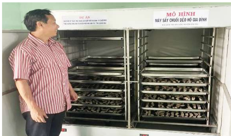
Kiểm tra thử nghiệm máy sấy chuối dẻo hộ gia đình.
