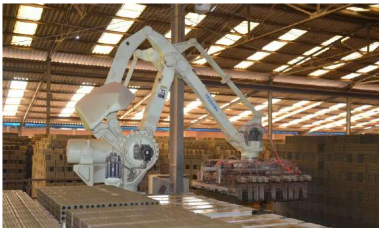
Nhà máy gạch Phú Điền, ở xã Hành Minh (Nghĩa Hành) ứng dụng rô - bốt bốc xếp gạch tự động, giúp giảm chi phí nhân công. Ảnh: Ý THU
