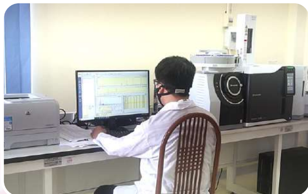
Hệ Thống máy sắc khí (dùng để phân tích dư lượng thuốc BVTV trong nông sản, hợp chất hữu cơ trong nước).
