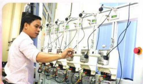
Kiểm định công tơ điện.
