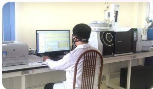
Hệ thống máy sắc khí (dùng để phân tích dư lượng thuốc BVTV trong nông sản, hợp chất hữu cơ trong nước).
