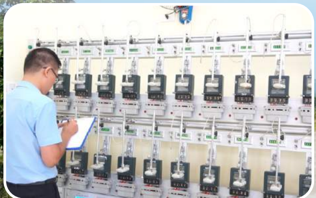
Kiểm định công tơ điện.
