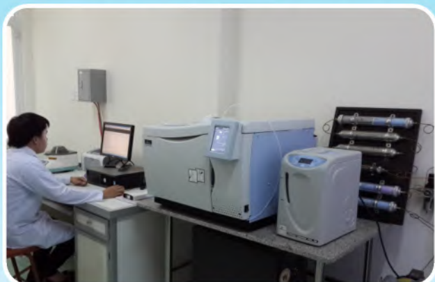
Hệ thống máy sắc ký khí (dùng để phân tích dư lượng thuốc BVTN trong nông sản, hợp chất hữu cơ trong nước).
