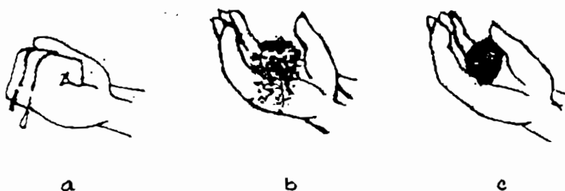
Hình 14: Cách thử độ ẩm của mặt của a. Dư nước c. Thiếu nước b. Đủ nước
