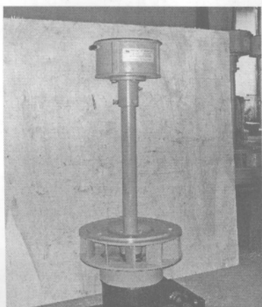
Hình 5. Tổ máy thủy điện cực nhỏ cho hộ gia đình
