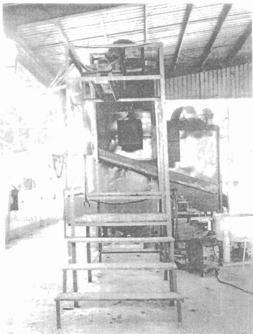
Hình 25 : Thiết bị chao dầu nhúng từng mẻ được cơ giới hóa của Việt Nam
