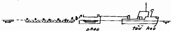
Hình 2.29- Vận chuyển thềm bằng phao
